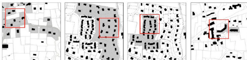
forme 1 forme 2 forme 3 forme 4 individuel "libre" individuel "avec procédure" individuel "groupé" collectif 5 log/ha 10 log/ha 25 log/ha 70 log/ha
